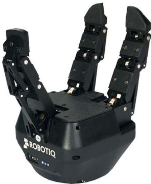
Fig. 2.26 – Modelos de garra articulada.
