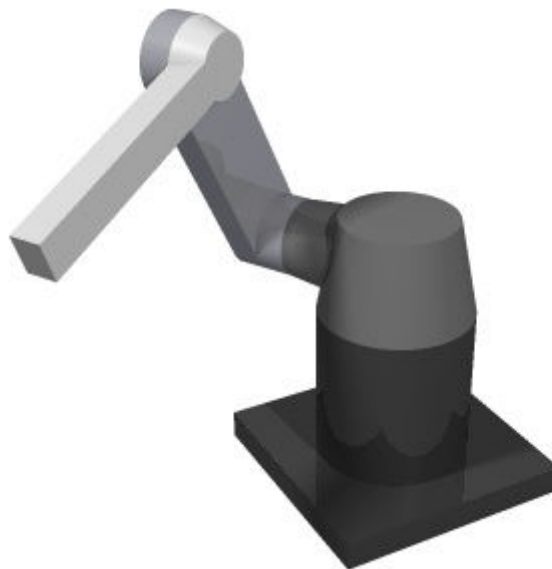
Fig. 2.17 – Robô articulado ou revoluto
